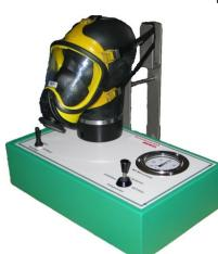
Prüfgerät Multitest 720M ermöglicht die automatische Prüfung und Dokumentation mittels PC von Normaldruck Masken und Lungenautomaten. Mit entsprechenden Zubehör ist die Prüfung von Überdruck Masken und Lungenautomaten sowie Schutzanzügen möglich. Durch seine einfache Bedienung sind Fehlbedienungen fast ausgeschlossen.
