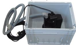
Wird benötigt, wenn der Wasserablauf für den Abtransport des Abwassers ohne Pumpe zu hoch montiert ist. Die Externe Abwasserpumpe besteht aus einer Auffangwanne und einer Tauchpumpe mit Abwasserschlauch. Über die automatisch gesteuerte Tauchpumpe wird das Abwasser abgepumpt sobald ein vorgegebener Füllstand in der Auffangwanne erreicht ist.
