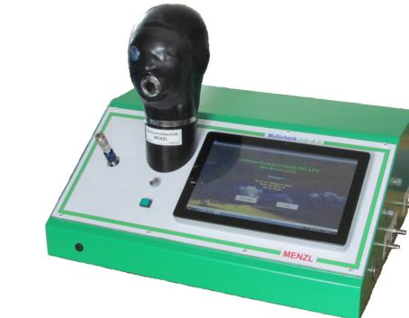
Mittels der eingebauten Pumpe sind Dicht-, Öffnungs- und Schließdruckprüfungen im Niederdruckbereich durchführbar.
